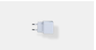
LD0490UA Alimentatore a spina con entrata USB-A (Poldina micro, Poldina sospensione, Poldina parete, Poldina picchetto, Swap, Swap mini, Push-up) USB-A port power charger (Poldina micro table lamp, Poldina suspension lamp, Poldina wall lamp, Poldina lamp with peg, Swap, Swap mini table lamp, Push-up table lamp ) INPUT: AC 100-240V | 50-60Hz OUTPUT: 5 V - max 1 A
